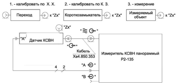
Рис.8.1. Структурная схема подключения для калибровки и измерения КСВН
