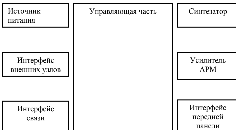
Рис. 4.3. Функциональный состав платы управления
